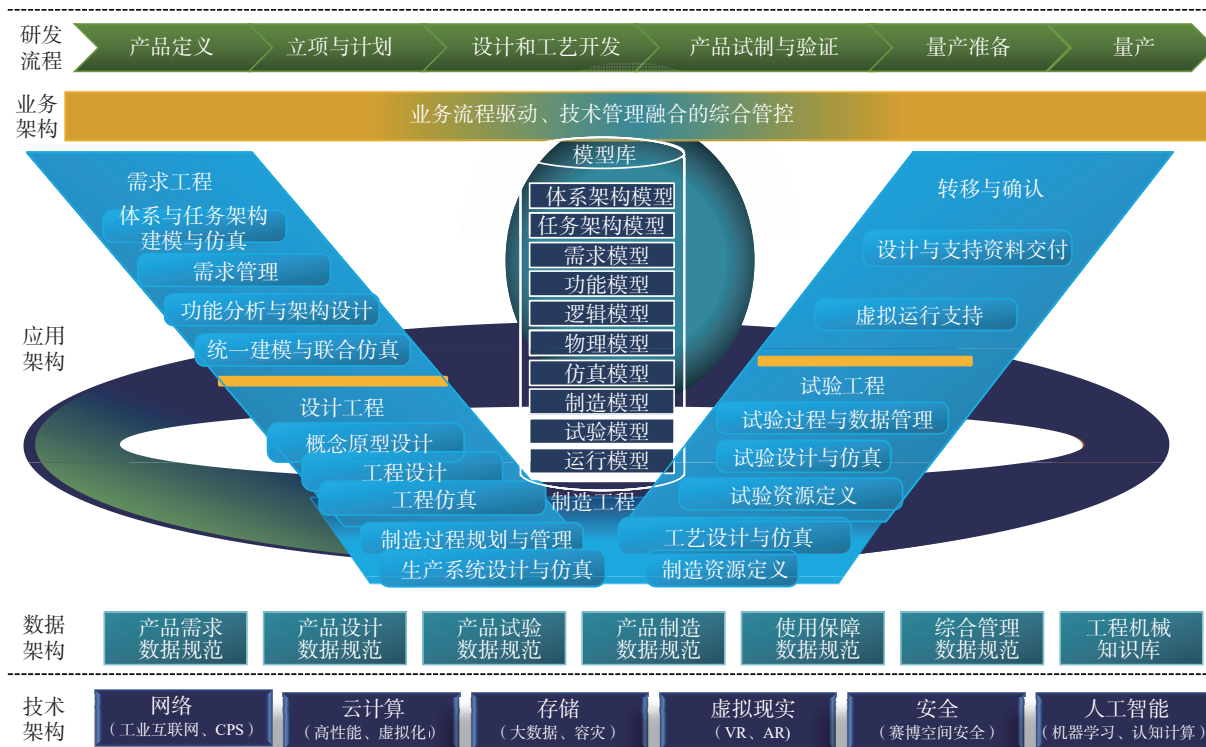
图1 基于模型的系统工程整体架构
